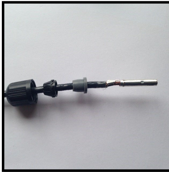
Fig 2. Sertissage réussi d'une cosse solaire.
